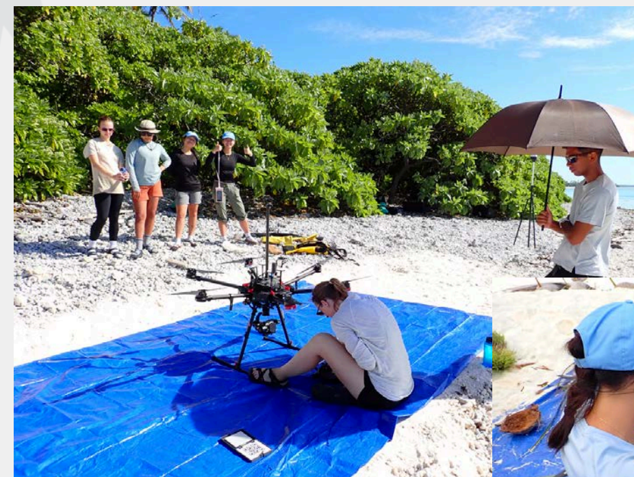
Mise en vol de drone pour images thermiques et multispectrales de la canopée
